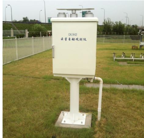
图5 DUH2云量自动观测仪
