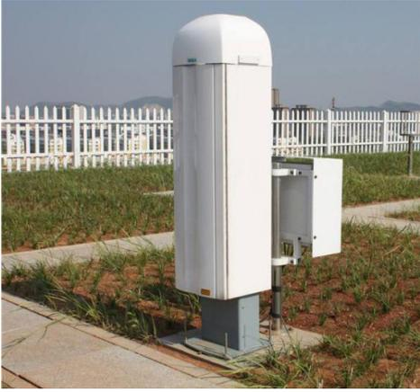
图2 芬兰维萨拉生产的CL31激光云高仪
