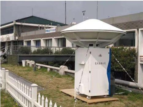
图3 观测场中的毫米波测云仪
