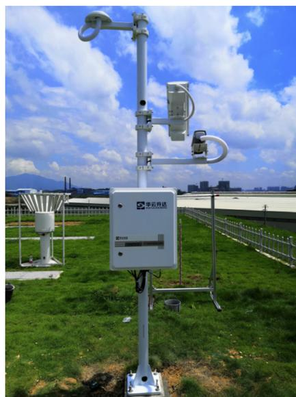
图7 天气现象视频智能观测仪(安装于广西南宁气象观测站)
